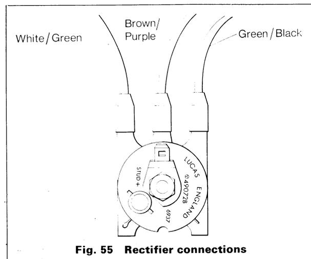
Fig. 55 Rectifier connections
