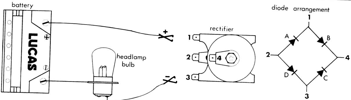
Fig. 69A Rectifier bench test
